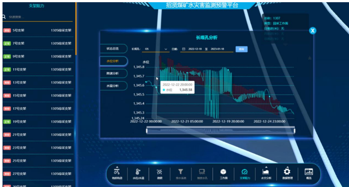
图 11 离层水害综合预警平台
